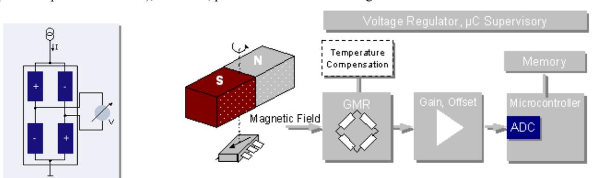
La excelente característica de este sensor magnético, es que es sensible a la orientación del campo magnético y no a su intensidad, con tal de que el campo esté en un rango entre 5... 15 kA/m. Esto significa que la señal de salida de este sensor es independiente de la posición relativa del sensor con respecto al imán en dirección lateral, axial o rotatoria, en el rango de varios milímetros. Los resultados óptimos se logran usando imanes permanentes o ruedas dentadas con polos magnéticos.
