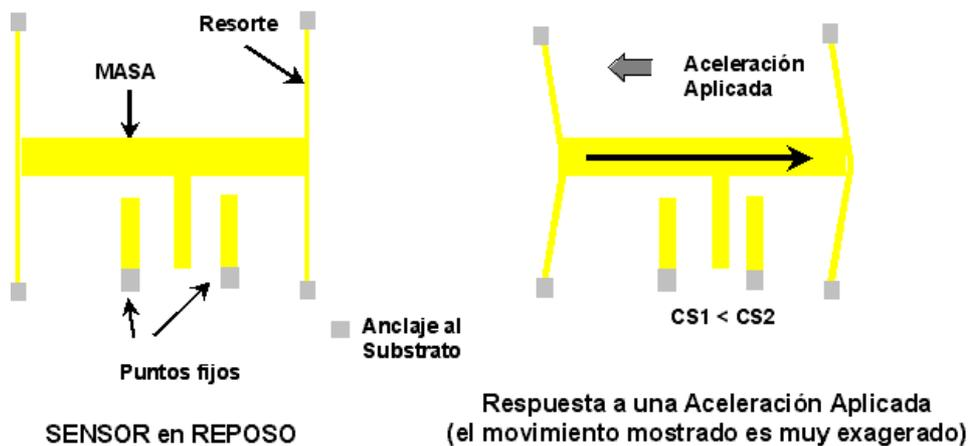
El dispositivo realmente trabaja en un lazo de control electrónico de fuerza/balanceo. Este lazo de control evita el movimiento de la masa en aceleración, por la aplicación de una fuerza igual pero opuesta creada por la aplicación de un voltaje en las placas del condensador. Este voltaje aplicado es directamente proporcional a la aceleración.
