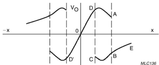
**Salida del Sensor en un campo magnético fuerte.**
