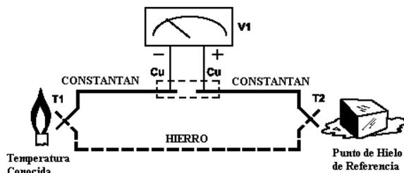
Voltaje del termopar con Referencia a 0° C.
