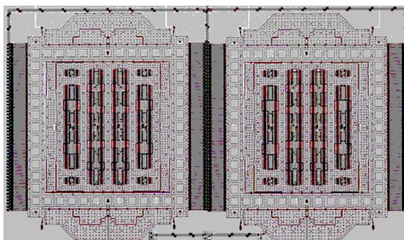
**Aplicaciones:** Control Dinámico de un Vehículo (VDC). Mide la velocidad sobre el eje vertical de un vehículo y compara el valor predictivo, por los sensores de velocidad de las ruedas, para ver si el vehículo se está deslizando. La mayoría de los sistemas VDC también incluyen acelerómetros de bajos g, que se usan para medir si el deslizamiento del vehículo es longitudinal para el control ABS o lateral para detectar pérdida de tracción.
