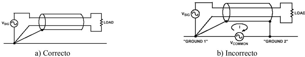
**Conexión del cable apantallado de un sensor.**
