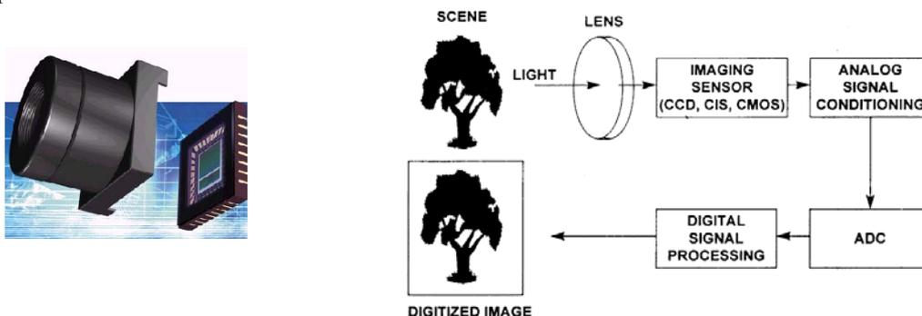
En el caso de salida con señal analógica, se puede procesar la imagen comprimiéndola en una de serie de estándar, como JPEG, MPEG.
