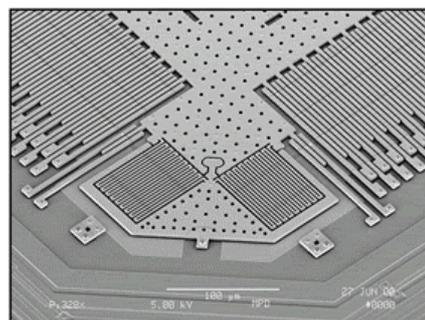
El sensor lo forma una superficie micromecanizada, es un minúsculo sensor de aceleración de movimiento en un circuito integrado de silicio de bajo coste. Solamente la superficie micromecanizada puede dar la combinación de alta seguridad en su funcionamiento y tamaño pequeño. El elemento sensor del acelerómetro mide cerca de 1 mm<sup>2</sup>.
