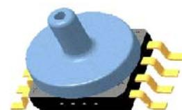
Los Sensores X-ducer™ es un sistema Patentado por *Motorola*. Una corriente de excitación circula longitudinalmente a través de la resistencia, puntos 1 y 3 de la siguiente figura, y la presión que se ejerce en el diafragma está aplicada en un ángulo recto con respecto al flujo de corriente. La tensión mecánica establece un campo eléctrico transversal en la resistencia, que está sensando como un voltaje en los puntos 2 y 4, que están localizados en el punto medio de la resistencia.
