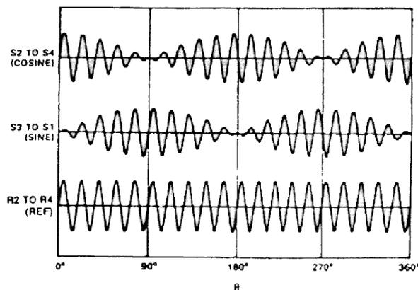
Nota: El estándar para la rotación de los Resolvers, es contar en dirección de las agujas del reloj (CW), moviendo el eje para un ángulo creciente como viéndolo desde el final del eje del transductor.
