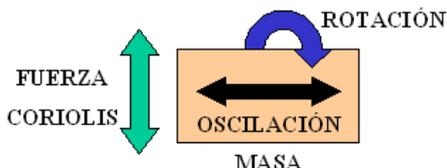
**¿Cuál es la fuerza de Coriolis?:** Cuando un objeto se mueve de una manera periódica (oscilando o girando), girando el objeto en un plano ortogonal a su movimiento periódico causa una fuerza de traslación en la otra dirección ortogonal.
