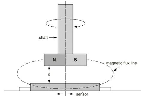
**Montaje del sensor y el imán.**
