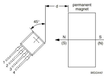
**Detector de Proximidad utilizando un sensor magneto-resistivo.**
