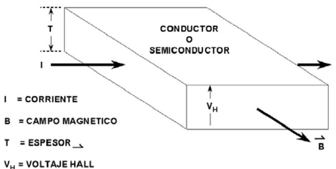
El efecto Hall se usa para hacer sensores de movimiento, particularmente en aplicaciones de posición y movimiento, lineal o rotatorio. *Analog Devices* ha integrado en un solo dispositivo el sensor y la circuitería de acondicionamiento para minimizar las derivas debidas a la temperatura asociadas a las características de la célula de silicio, con la familia AD22xxx.
