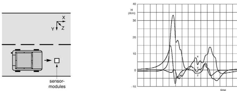
El campo local geomagnético fue calibrado a cero, de modo que solamente sería registrado el desajuste en el campo provocado por el vehículo cuando pasa. El módulo sensor también demostró ser lo suficientemente sensible para detectar y distinguir motos (hasta con motor, marco y ruedas de aluminio), que producen espectros como los de la figura siguiente, desde el lateral de la carretera.
