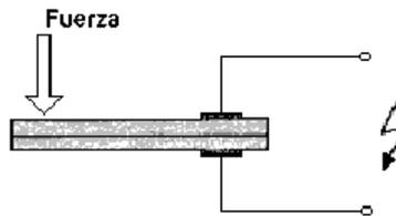
2. **Sensores de Presión con Semiconductores:** Una variación de presión sobre una membrana, hace actuar un único elemento piezo-resistivo semiconductor. *Motorola* fabrica sensores de presión con su familia MPX.
