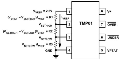
Evidentemente el total de las resistencias ( $R1 + R2 + R3$ ) es igual a la resistencia de carga necesaria para la corriente de histéresis  $I_{vref}$  determinada al principio del procedimiento. Para un fácil cálculo, *Analog Devices* ha creado un software gratuito, que permite determinar todos los valores necesarios, sin necesidad de ninguna operación matemática.
