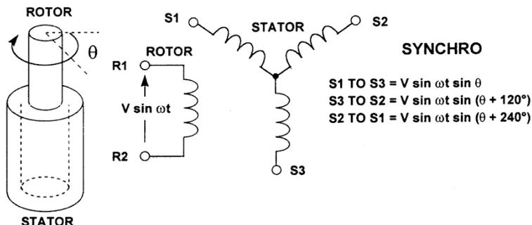
El voltaje inducido en un estator por el rotor, será proporcional al seno del ángulo  $\theta$  entre el eje de la bobina del rotor y el eje de la bobina del estator. El voltaje inducido en un par de terminales del estator será la suma o la diferencia de los voltajes, dependiendo de la fase, a través de las dos bobinas concernientes. El voltaje de excitación del rotor, aplicado a los terminales R1 y R2, es de la siguiente forma:  $A \sin \omega t$
