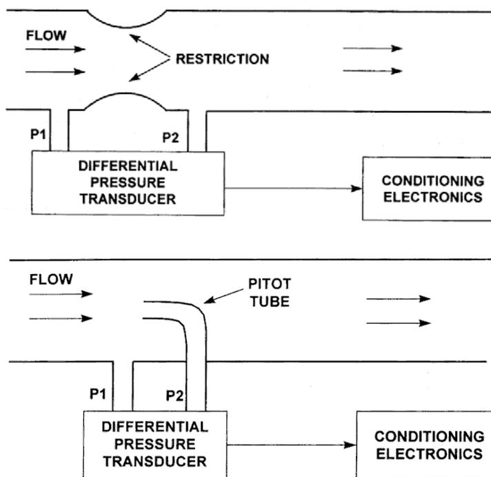
Dos montajes para la aplicación de medida de caudal por diferencia de presión.
