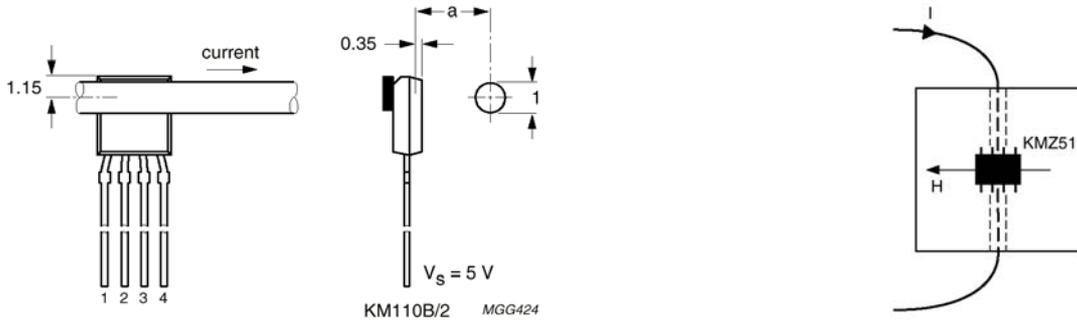
**Medida de corriente de un conductor y de una pista de circuito impreso utilizando un sensor MR.**
