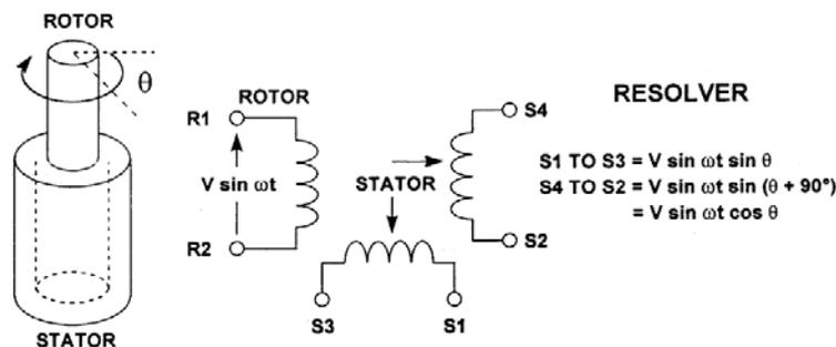
Los voltajes inducidos (en los secundarios) son modulados en amplitud por el seno y el coseno del ángulo  $\theta$  del rotor relativo al del estator. El voltaje de excitación es de la siguiente forma:  $A \sin \omega t$
