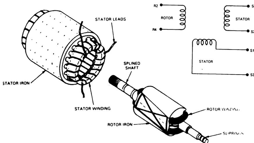
En la figura se muestra la estructura electromecánica de un sincro y la representación eléctrica equivalente.
