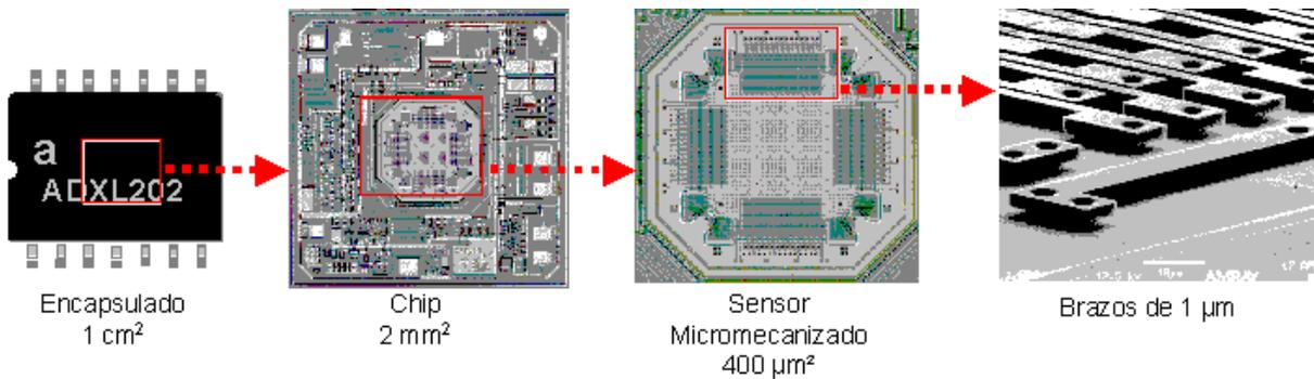
**6.1.3 Funcionamiento del sensor micromecanizado**
