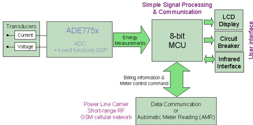
El siguiente esquema muestra otro circuito que además de medir la corriente y la tensión, procesa la medición dando como resultado unos impulsos proporcionales a la potencia para atacar directamente a un contador de energía mecánico.
